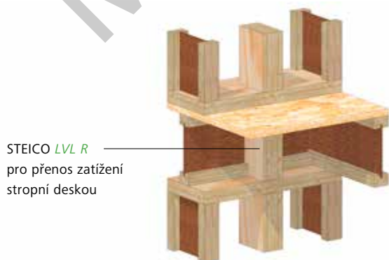
F5 Přenos vysokých bodových zatížení stropní deskou
