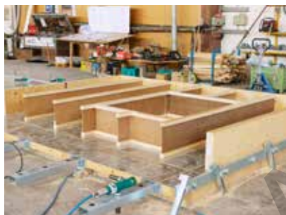
Nosníky STEICOWall tvoří nosnou konstrukci stěn. Základní rám je ze STEICO LVL R.
